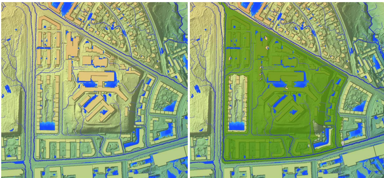
Figur 38: Oversvømmelsesanalyser fra SCALGO. Det ses at der omkring bygningerne er risikoområder. Vand fra disse områder ledes formentlig på nuværende tidspunkt væk i kloakken. Derudover ses det på figuren til højre, at vand fra hele grunden naturligt strømmer til Silkeborgvej, hvorfra det løber til Aarhus Å.
